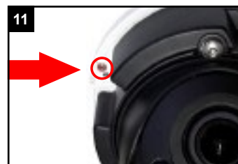
Inbus-Schraube feste anziehen, um Kamera an Montageplatte zu sichern.
