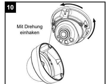
Kamera an Montageplatte einhaken
